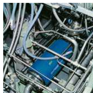
Caudalímetro KRAL instalado en el compartimento del motor de un yate.
